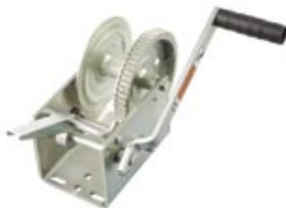
Art. nr 1037 1136 kg dragkraft med slirbroms Utväxling 5.5:1, 17.1:1
