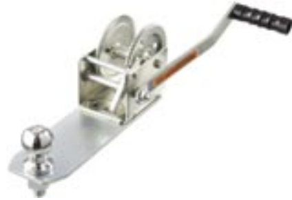
Art. nr 1186 En robust hjälpvinsch för trailer och husvagnar. Dragkraft 635 kg, utväxling 4.5:1 med dubbelspär. Levereras komplett med fästplatta, 50 mm kula, vinsch samt 17 meter lina och krok.
