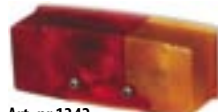
Art. nr 1342 Baklampa Jokon, höger kompl. utan glödlampor Vänster art. nr 1342-1 Löst glas höger art. nr 1343 Löst glas vänster art. nr 1343-1
