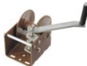
Art. nr 1372 Säkerhetsvinsch, 681 kg dragkraft Utväxling 30:1
