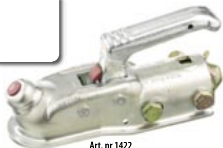
Art. nr 1422 Kulkoppling, typ AK 300 3000 kg, 50 mm för rundrör 35 mm, 40 mm, 50 mm
