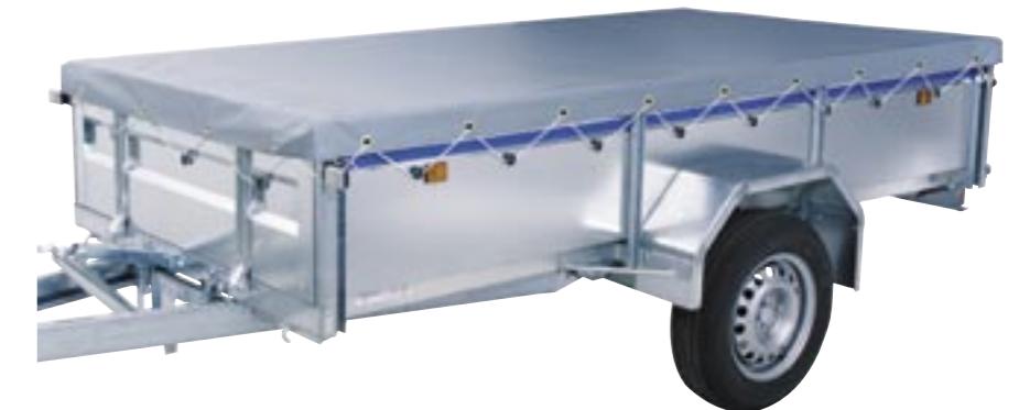
Flakpress, skyddar lasten mot väta och vind. Figursydd omlott med resårband i öljetter, 600gr PVC.
