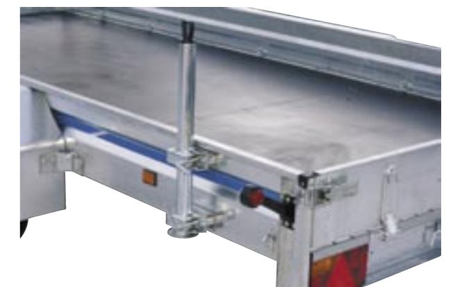
Kraftiga stödben bak standard för stabil pålastning.
